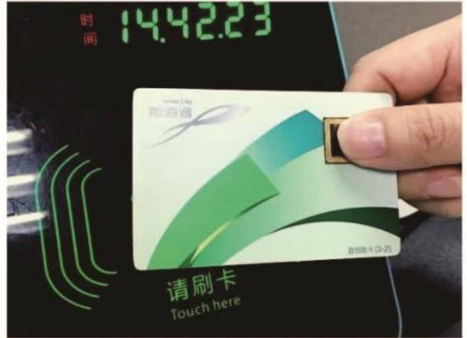
RFID 非接触式 IC 卡
