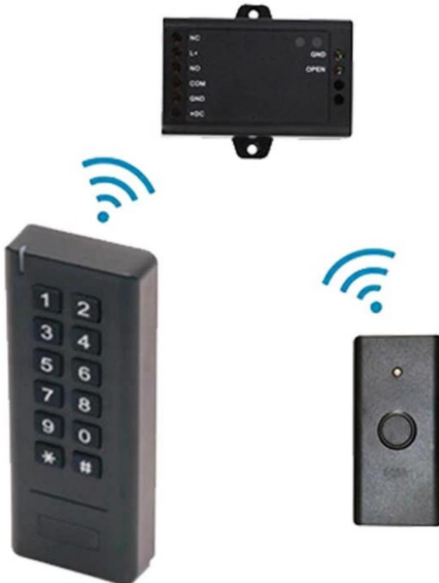
Der ACM404 ist eine eintürige drahtlose Zugangskontrolle, die aus einer drahtlosen Tastatur, einem Mini-Controller und einer drahtlosen Ausgangstaste besteht. Der TEA + Rolling Code des Verschlüsselungsalgorithmus und das geteilte Design garantieren eine höhere Sicherheit.
