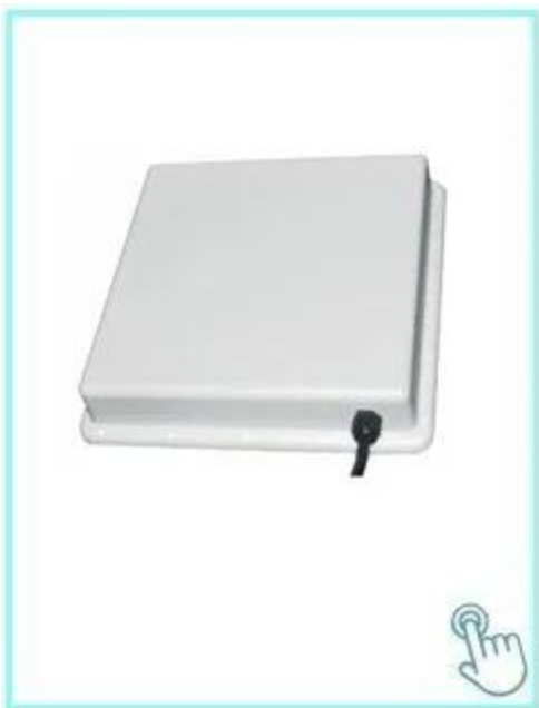
ACM812A UHF-Lesegerät mit 2 bis 5 m Reichweite Wiegand 26-Ausgang, RS232 / 485
