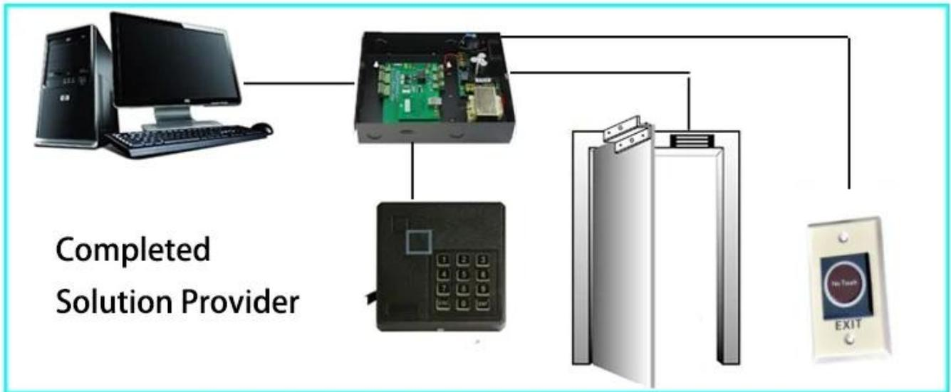
Wir können ein komplettes Türzugriffskontrollkit wie: EM-Lock, Sperrklammer, elektrische Bot-Sperre, Netzteil, Zugangscontroller, WIEGAND RFID-Reader, Stand-Alone-RFID-Leser bereitstellen. Klicken Sie auf das folgende Bild, um mehr Details zu finden.
