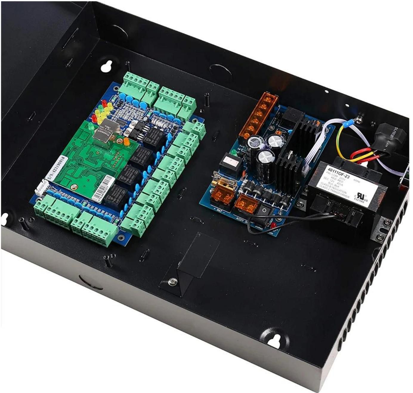
Stromversorgungskasten Ausgang 12V DC einschließlich WIEGAND 26 Bit Vier Door Security Panel
