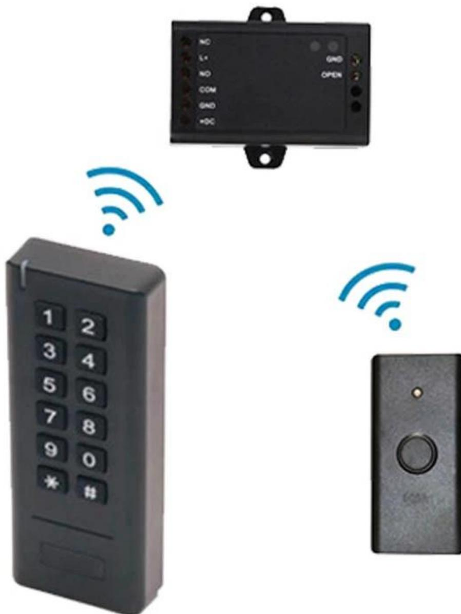
El ACM404 es un control de acceso inalámbrico de una sola puerta, consta de un teclado inalámbrico, un mini controlador y un botón de salida inalámbrico. TEA + Rolling Code del algoritmo de cifrado y el diseño dividido garantizan una mayor seguridad.
