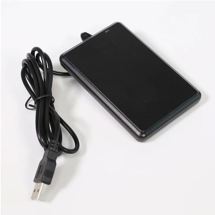
Frecuencia: 13.56MHz + 125KHz (frecuencia dual)
