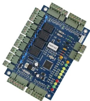
Assemblée PCB du système de contrôle d'accès ACM-RS04 / vert
