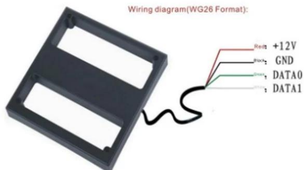
Wiring diagram(WG26 Format):
