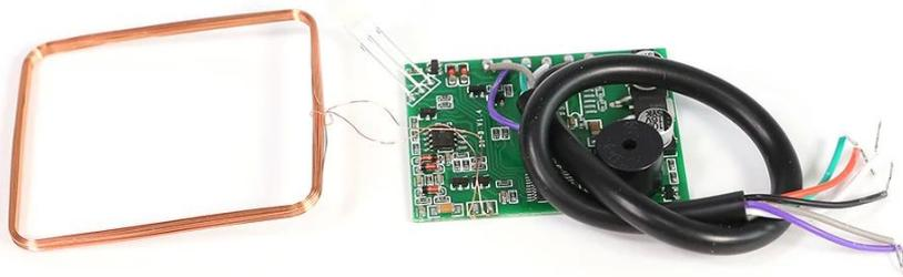
**Sistema de entrada usar faixa passiva HF LF Módulo leitor RFID controle de acesso Módulo leitor de cartão de frequência duplo**
