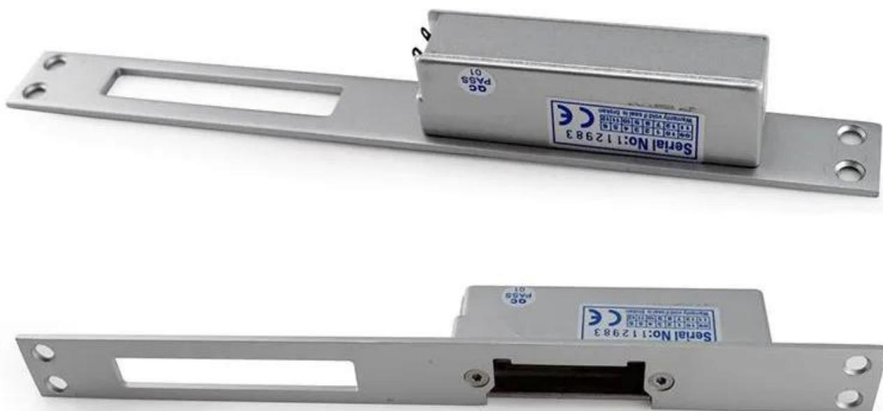
ACM-Y131 NO / NC é a greve elétrica com placelho longo. Tem dois modos: um ataque elétrico seguro de falha precisa de energia para mantê-lo bloqueado. Uma falha segura elétrica fica bloqueada mesmo sem poder. Greves elétricas vêm em muitas variedades.
