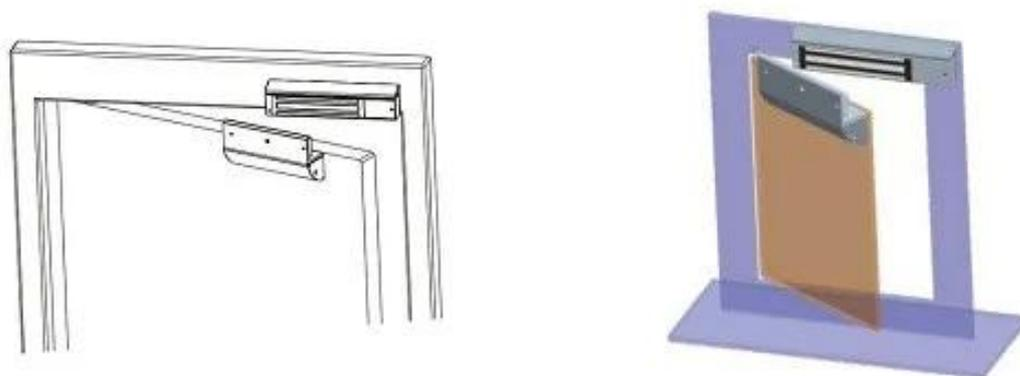
Это 180 кг 280 кг стиль ZLC магнитный замок кронштейн для системы контроля доступа требуется в паре с магнитными замками для распашных дверей. Наши замки-скобки изготовлены из специального алюминия, прочные и долговечные. Кронштейн гарантирует, что магнит остается на защищенной стороне дверей, лучший выбор контроля доступа. Магнитные замки отлично подходят для зон с низким, средним и высоким трафиком, таких как офисы, мини-маркеты, входы и выходы в здания.
