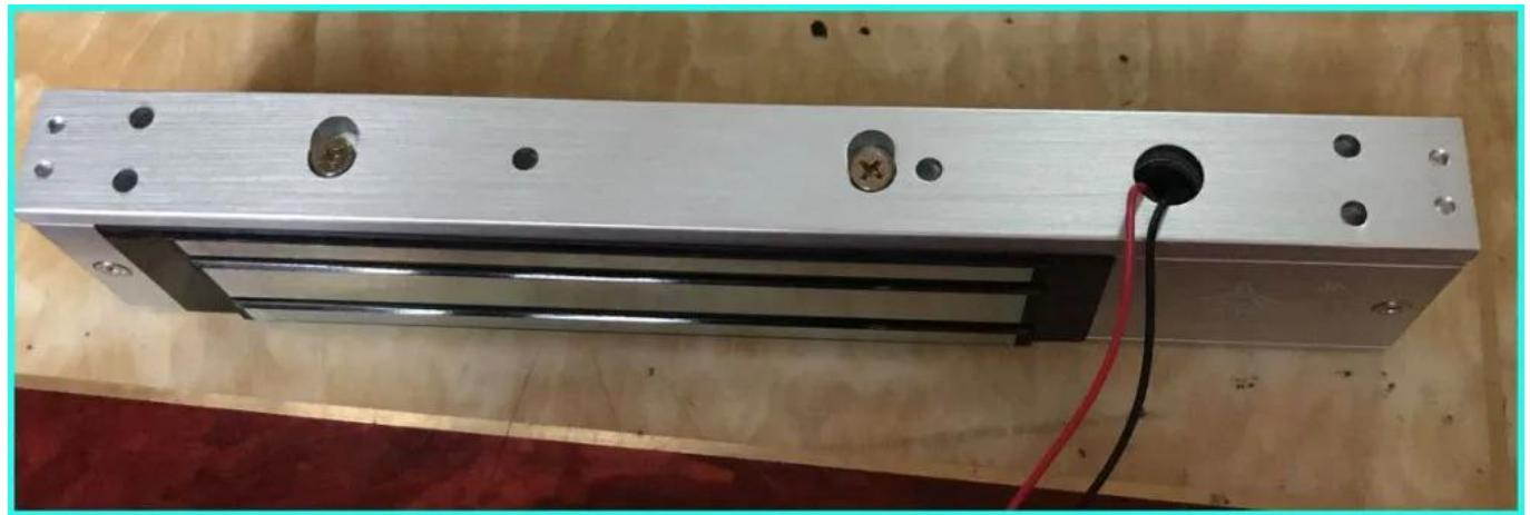
Наш замок со светодиодной подсветкой, чтобы показать рабочую статую, свет зеленый при блокировке, красный при разблокировке . Светящуюся статую можно изменить.
